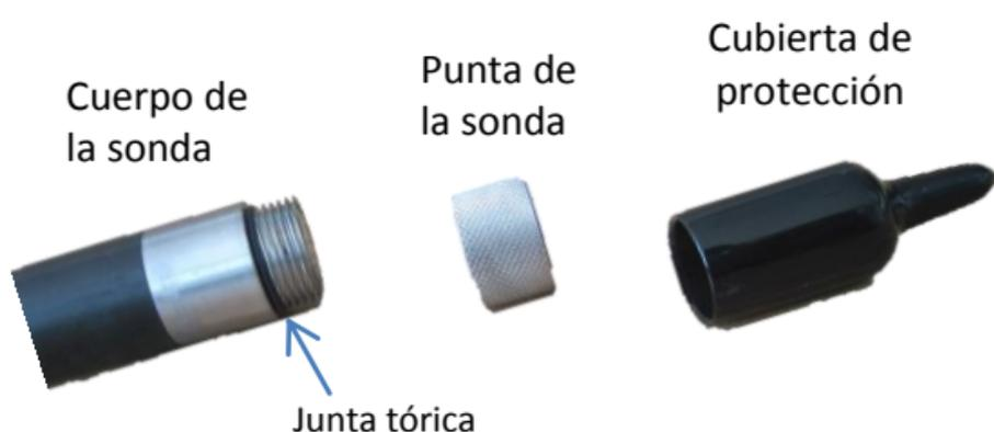
Este accesorio STDO21 es una sonda de luminiscencia para medición de oxígeno disuelto (DO) que necesita muy poco mantenimiento. Realice la calibración antes del primer uso; posteriormente, la sonda no necesitará calibración sino después de algunos meses. Recomendamos al cliente que sustituya la **punta de la sonda** aproximadamente **cada 12 meses** o cuando el desempeño del STDO21 ya no sea satisfactorio.
